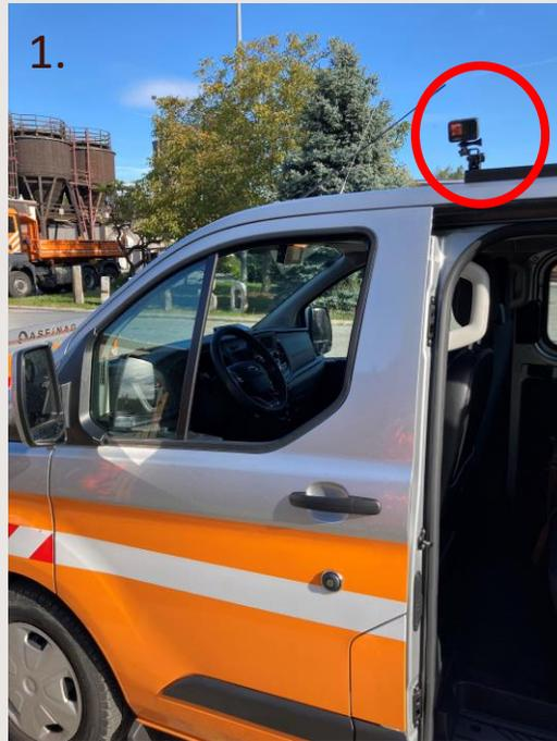
1. Eine Kamera wird am Fahrzeug montiert
