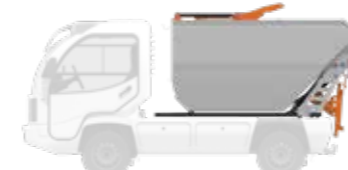
MLP - Abfalltransportwanne Hochentleerer mit Mülltonnenlift und Müllpresse
