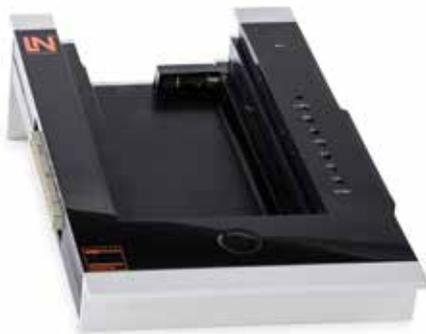
Experimentierkoffer zur Aufnahme von Experimentierkarten, Multimeter oder Breadboard und zur Bereitstellung weiterer Experimentierspannungen.
