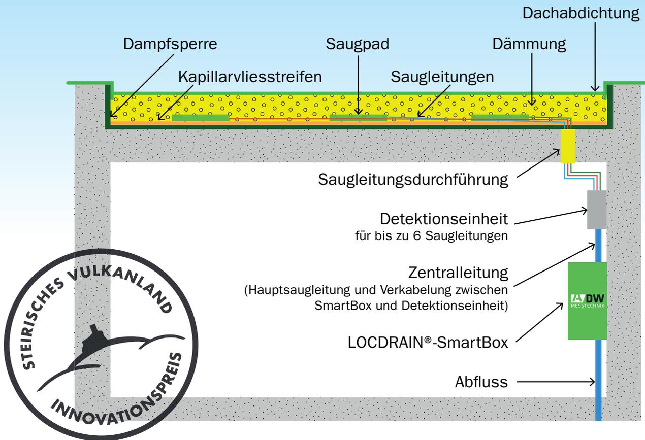
LOCDRAIN® ist ein innovatives System, das frühzeitig Leckagen, Undichtheiten erkennt und effektiv Wasser abführt. Dadurch wird die Lebensdauer von Gebäuden erheblich verlängert und Reparaturen können stressfrei durchgeführt werden, bevor unerwünschter Wassereintritt zu Folgeschäden führt. LOCDRAIN® ist das einzige System auf dem Markt, das nicht nur Wasser detektiert, sondern auch entfernt.
