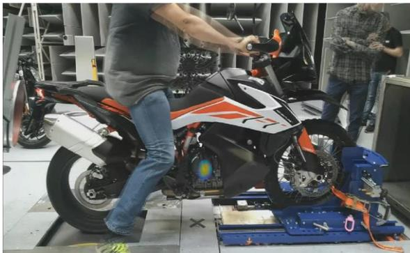
**Problem:** Feinlokalisierung dominanter Schallquellen unter Volllast auf Rollenprüfstand
