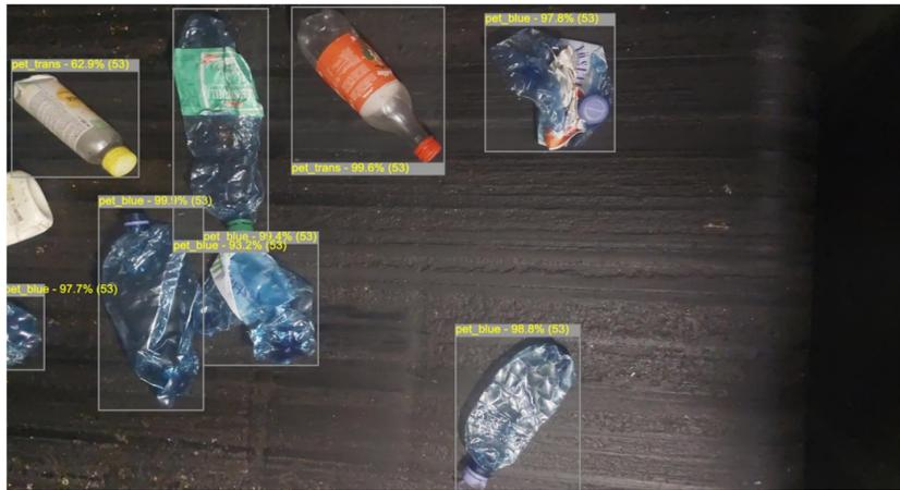
B-AI ermöglicht die vollautomatische Erkennung von derzeit 12 Stoffgruppen
