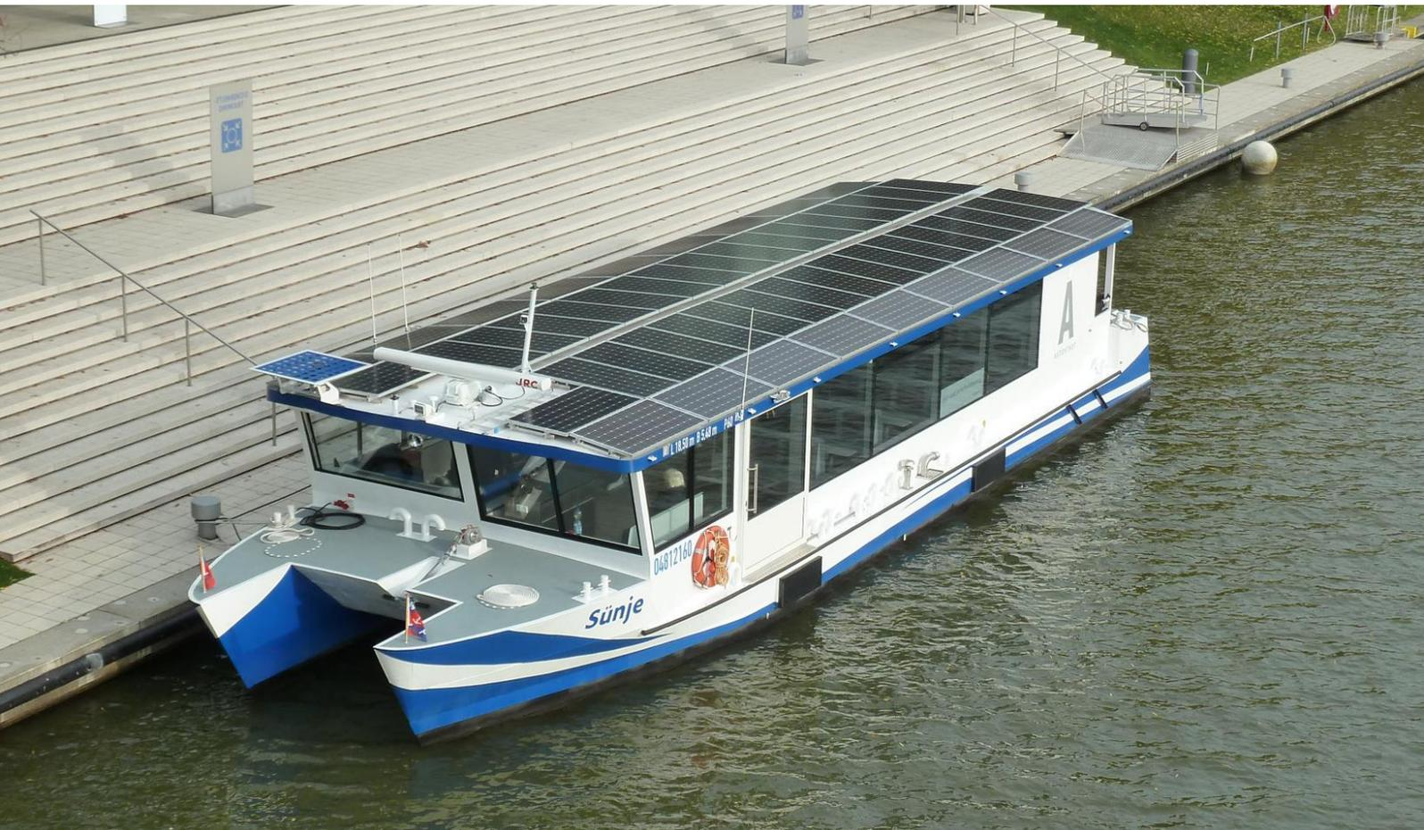
Fahrgastschiff PAX60 in der Autostadt Wolfsburg, angetrieben mit 2 Stück KRP 25
