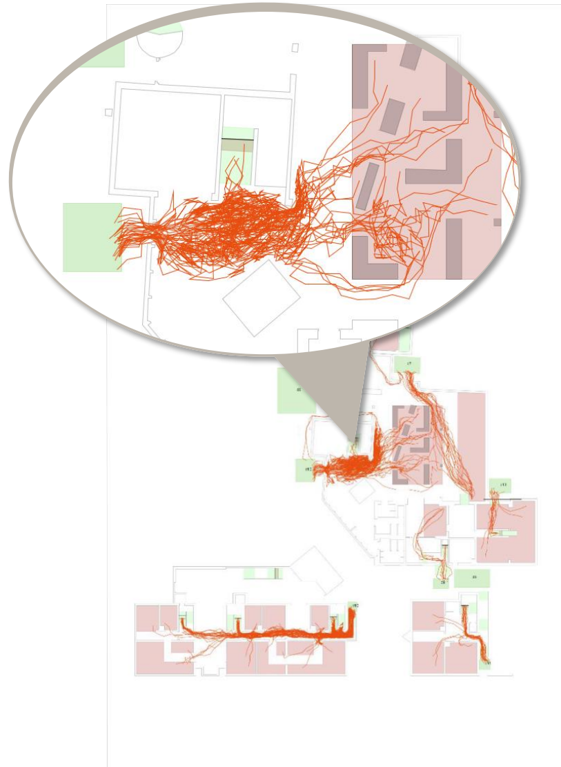
Entfluchtungsanalyse: Wege der Fußgänger im EG
