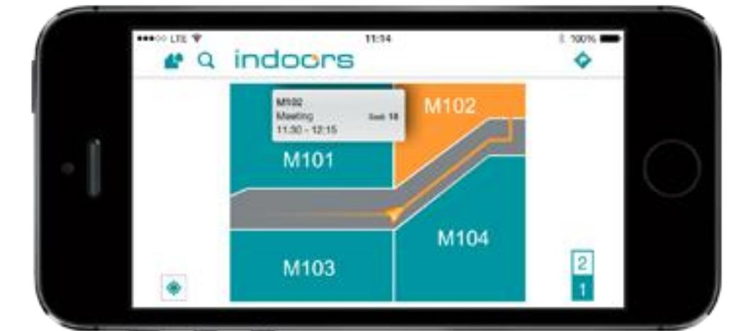
**iBEACON** sendet via Low Energy Bluetooth 4.0 (BLE) alle paar ms ein konfigurierbares Signal. Dieses kann das Smartphone zur Ortung verwenden und z.B. eine lokale Push-Notifikation ausführen.
